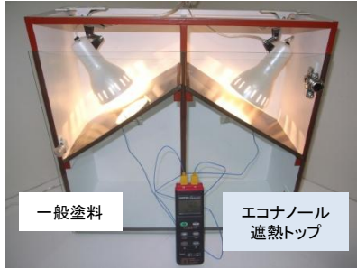
屋根遮熱実験
